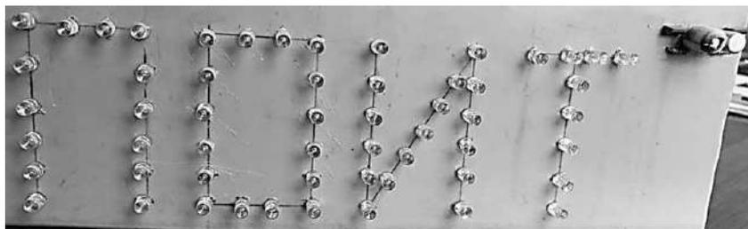
Рисунок 2 – Получившаяся вывеска с мультивибратором
